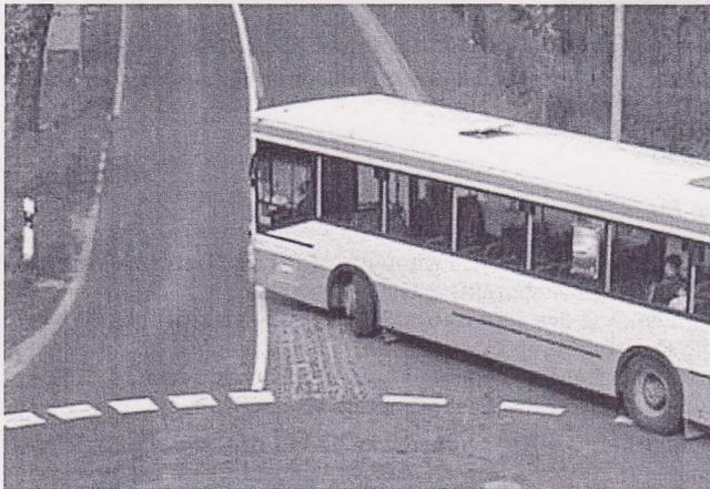
**Bild 23: Teilweise überfahrbarer Fahrbahnteiler an einem Minikreisverkehr**
